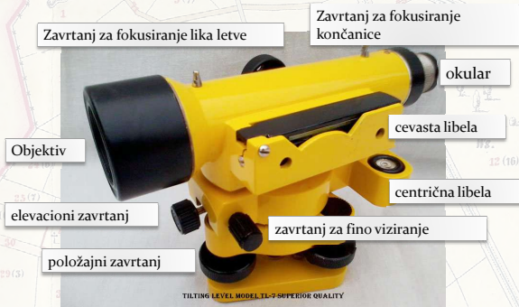
Nivelmanski instrument - funkcionalni delovi.
